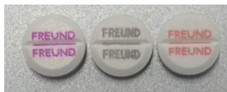
Fig. 7 割線内への印刷
