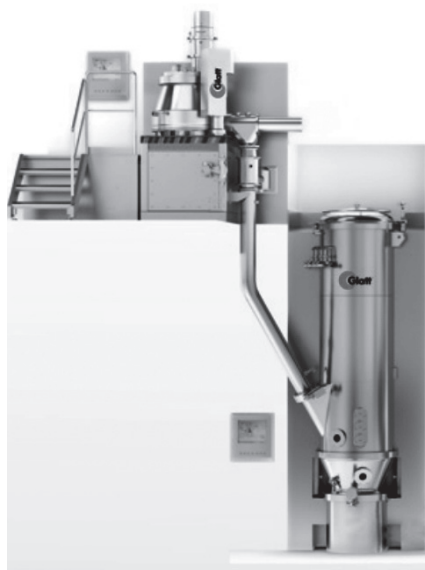
Fig. 9 攪拌混合造粒機と流動層造粒乾燥・コーティング機の連動運転 (カタログ、MultiLab より: glatt.com)
